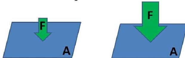
Abb. 2: Vergrößerung des Drucks durch Vergrößerung der Kraft
