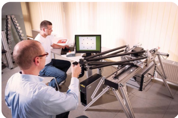
Roboterarm, der die Interaktion mit neuen Objekten (z. B. neuer Tennisschläger oder neues Werkzeug) simuliert und die physikalischen Eigenschaften des simulierten Objekts in Echtzeit ändern kann.
