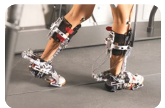
Das im JuBot-Projekt entwickelte Exoskelett für untere Extremitäten
