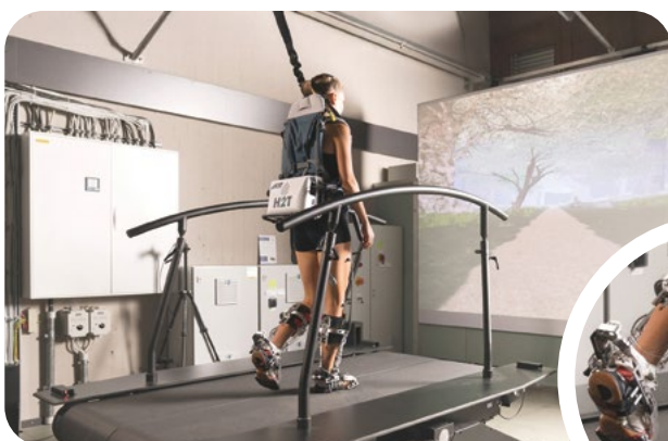
Probandin beim Gehen auf dem Laufband mit Sprunggelenk-Exoskelett (Kooperation Arbeitsgruppe Prof. Asfour)
