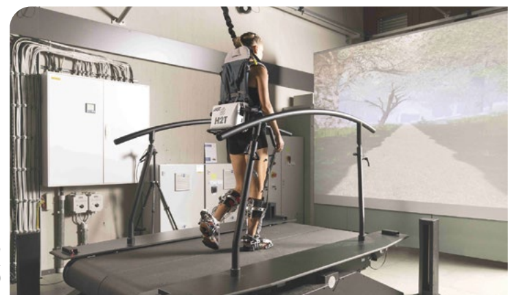
BioMotion Center: Probandin beim Gehen auf dem Laufband mit Sprunggelenk-Exoskelett (Kooperation Arbeitsgruppe Prof. Asfour)
